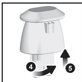
4. Insérer le capteur dans le boîtier, tourner et cliquer vers la droite pour bien fermer.
