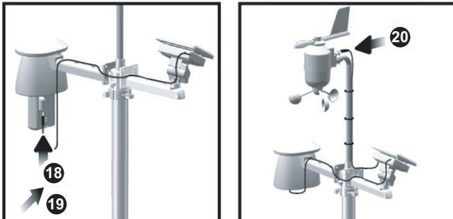
18. Retirer le capteur extérieur de son boîtier. Brancher le câble du panneau solaire dans la prise.
