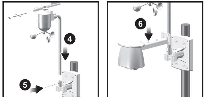
4. Insérer le capteur de vent dans le haut du collier.
