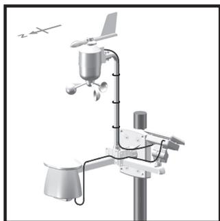
**AUTRE MONTAGE : CAPTEUR DE TEMPERATURE / HUMIDITE MONTE SEPAREMENT**
